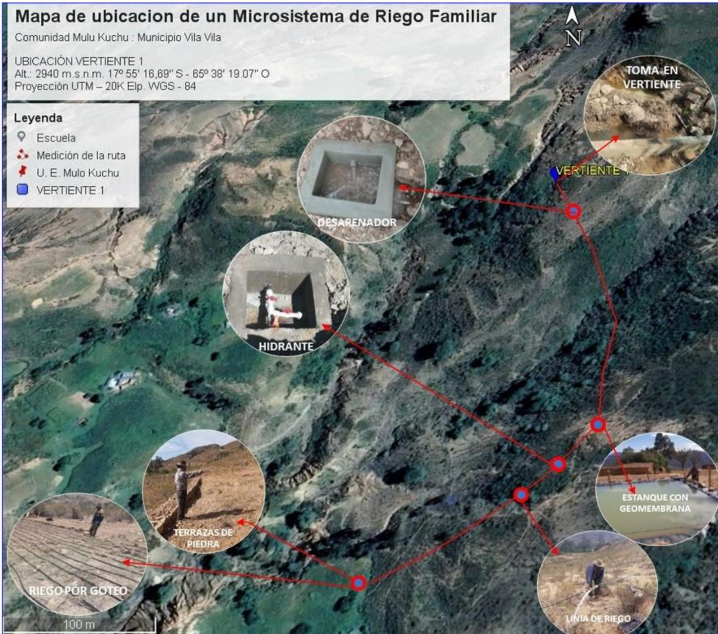
Figura 7 – Ubicazione delle opere di captazione idrica da realizzare nella comunità di Mulu Kuchu
