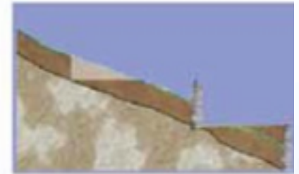
La tierra excavada es usada para llenar el terraplén
